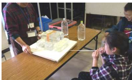
息を吹き込み、エアバックを膨らませて持ち上げます。5ℓの水なら楽に持ち上げられます。では、自分自身は持ち上がるかな？
